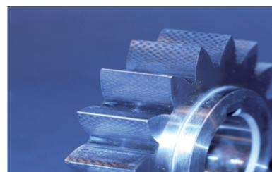
Test de engranajes según el ensayo de desgaste DIN / sin desgaste / marcas de mecanizado aún visibles
