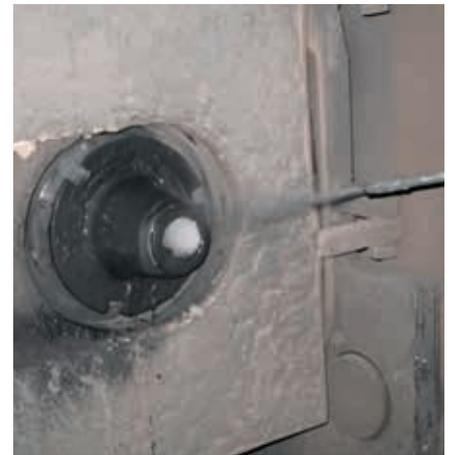
Heißsprühen Auslaufkonus Ausguss (Schattenrohraufnahme)
