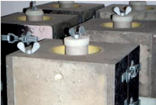
Gießform für die Herstellung gegossener keramischer Bauteile
