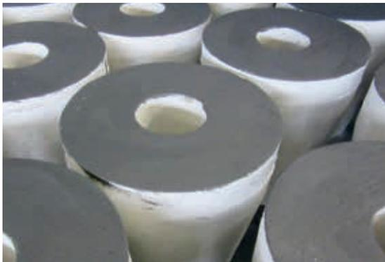
Kaltbeschichtung Dichtfläche keramische Schieberhülse
