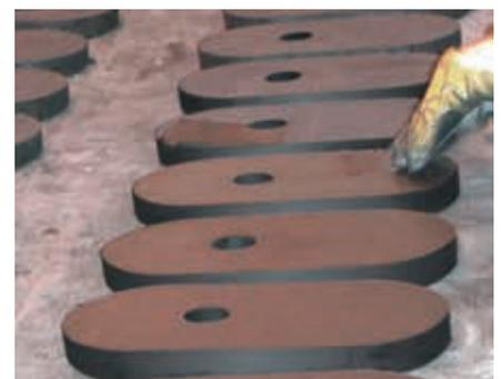
Händische Oberflächenbeschichtung keramischer Schieberplatten
