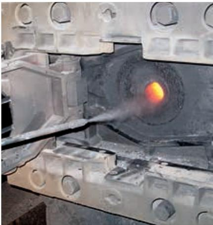
Heißsprühen, Verbindungsfläche eingebaute Schieberhülse/Kopfplatte
