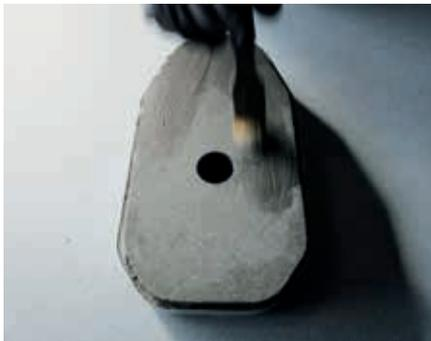
Oberflächenbeschichtung (händisch) keramische Linearschieberplatte
