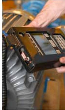
Monitorización de la condición mecánica de elementos rotativos, mediante detección temprana de fenómenos como desalineación, aflojamiento de fijaciones y desequilibrio dinámico. Recomendada para diagnóstico de motores eléctricos y compresores.
