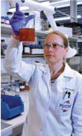
Monitorización del estado de lubricación de máquinas y predicción de la vida del lubricante. Permite tomar medidas como la reparación/sustitución de elementos mecánicos y es imprescindible para programar el cambio de aceite en instalaciones de refrigeración y de aire comprimido, determinando la necesidad de un proceso intermedio de flushing.
