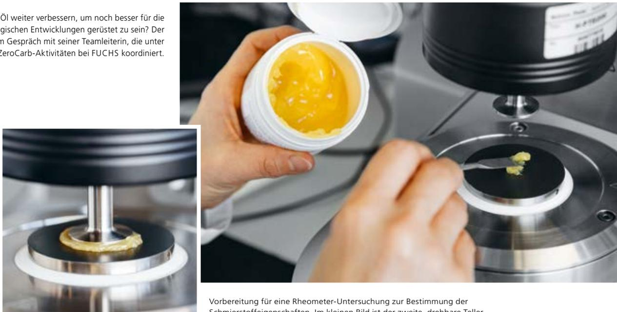
Vorbereitung für eine Rheometer-Untersuchung zur Bestimmung der Schmierstoffeigenschaften. Im kleinen Bild ist der zweite, drehbare Teller in Startposition für die Messung. Anschließend senkt sich auch die schwarze Haube und verdeckt den Blick auf die Messsteller – sie erlaubt es, die Temperatur auf vordefinierte Werte zu regulieren.
