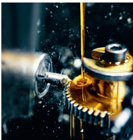
Sono prodotti a base di olio minerale più esteri e speciali additivi lubrificanti. Contengono anche antiossidanti e inibitori di corrosione per preservare i manufatti e la macchina utensile.
