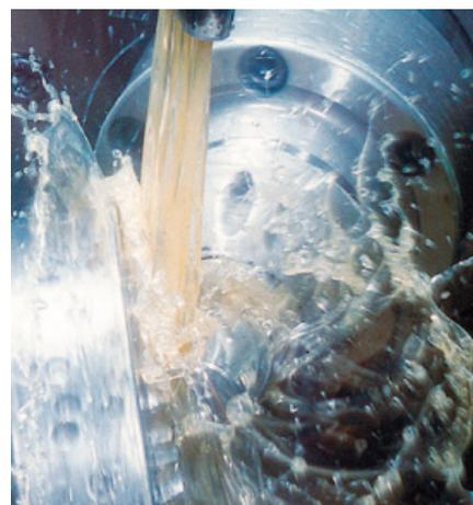
Questi lubrificanti sono esenti da olio minerale e sostanze untuose. Non possiedono un potere lubrificante ma hanno eccellenti proprietà antiruggine e raffreddanti.
