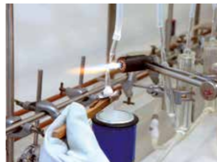
Próba szczelności rurki
